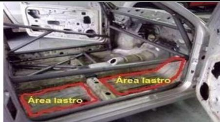
4.6 - Os lastros devem ser fixados no monobloco/carroceria com contra Placas de +- 50% do lastro, através de parafusos M8 no mínimo, classe 8.8 no mínimo, conforme Anexo J/FIA.
