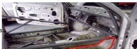
Os lastros devem ser fixados no monobloco/carroceria com contra Placas de +- 50% do lastro, através de parafusos M8 no mínimo, classe 8.8 no mínimo, conforme Anexo J/FIA.
